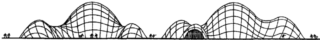
Figura 3. Estructuras de sistema de piel tensa
